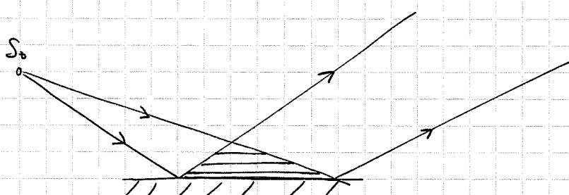
Dans ce dispositif très simple, on fait directement interférer la lumière issue d'un point (ou d'une faible source) avec celle qui s'est réfléchie sur un miroir.
