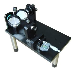
L'interféromètre est un modèle OVIO E1011, il est éclairé par une lanterne C1010 12V-75W. Dans cette expérience, on s'est rapproché du contact optique avec une source mercure C3030. On se propose d'aller vers la teinte plate, directement avec une lampe blanche, en observant les cannelures du spectre en plaçant l'extrémité fibre optique de SpectroVio II dans le champ d'interférences.
