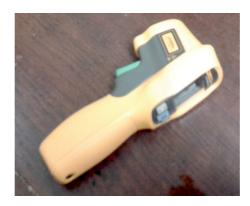
La température est déduite de la puissance du rayonnement infrarouge captée. L'angle dans lequel est collecté ce rayonnement vaut 54° (à 90% de l'énergie) Caractéristiques générales
