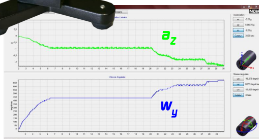
Etude des forces, vitesses et accélérations d'un mobile en rotation. Mesure de la force centrifuge.
