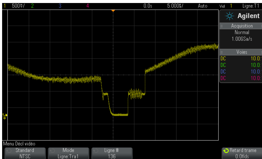
Figure 27 Exemple : déclenchement sur la ligne 136
