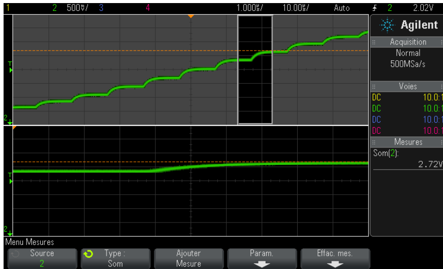
Figure 45 Isolation d'une zone à des fins de mesure du sommet
