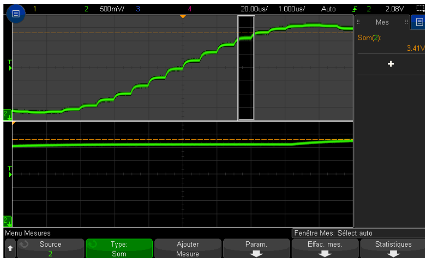
Figure 47 Isolation d'une zone à des fins de mesure du sommet
