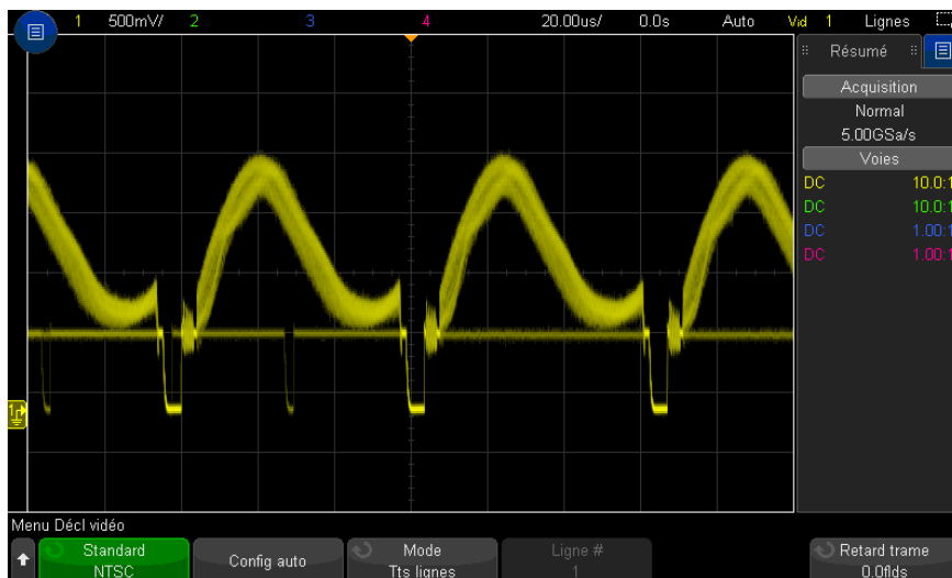
Figure 29 Déclenchement sur toutes les lignes
